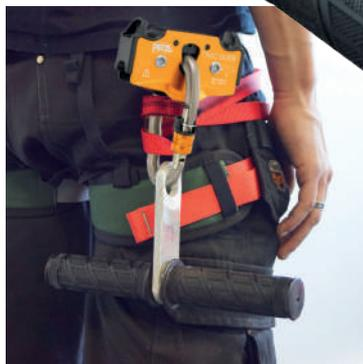
Poignée à fixer sur la poulie placée sur le baudrier de l'utilisateur.
