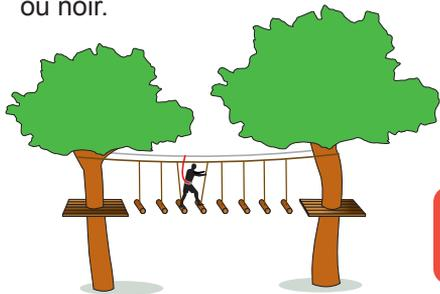
Munie d'une suspente en cordage Ø 20 mm.
